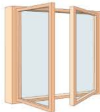
fenêtre F à la française F French casement window ventana F a la francesa F Drehflügel M nach innen finestra F a battenti M con apertura F all'interno M
